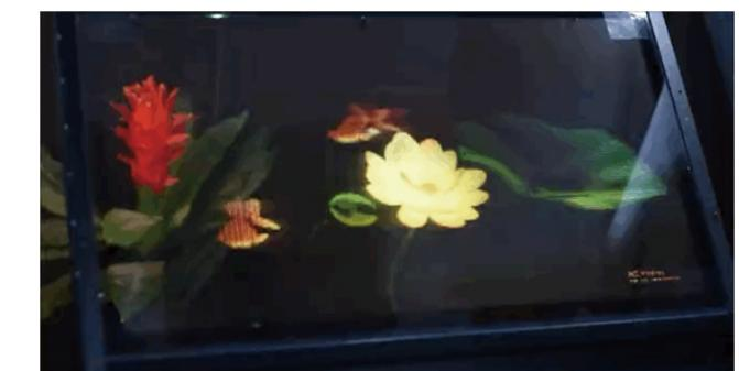
研究团队提出的基于空间复用的裸眼增强现实全息融合屏幕与投影仪结合，首次实现了32英寸、宽视场、彩色且具有运动视差的三维动态虚实融合彩色显示。此外，该器件结构制备速度快，使用纳米压印技术可实现批量复制，为今后大幅面高品质虚实融合动态三维显示提供了全新解决方案。
