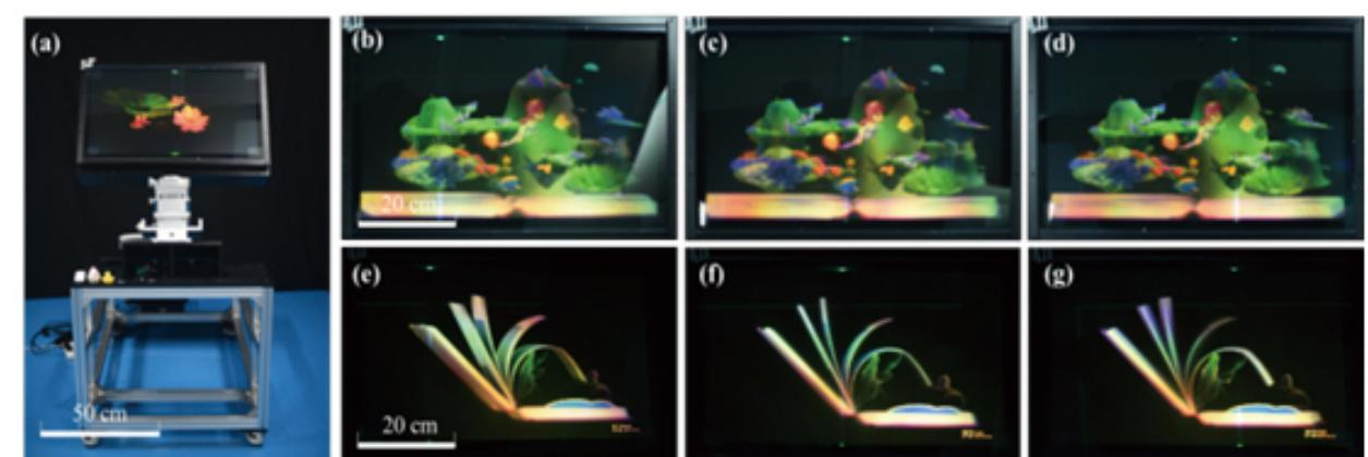
案，针对不同的光谱特性设计相应像素图案实现彩色显示。通过投影仪与全息融合屏幕的结合，实现了水平16视角的精确调控，获得了视场角为47°的真三维彩色显示效果，重现的3D图像具有水平连续的运动视差。
