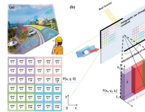
研究团队设计了可透过可见光线，并对特定角度入射光线精确调控的全息融合屏。其特征参数为：167,961,600个像素化纳米结构，32英寸幅面，3层空间复用排布，40Tbit海量数据。纳米光栅结构空间频率变化范围是357-2886line/mm，最小周期变化为0.645nm。其难度相当于将头发丝粗细的结构，有序排布在足球场大小的平面内。这样的结构还要排布三层。
